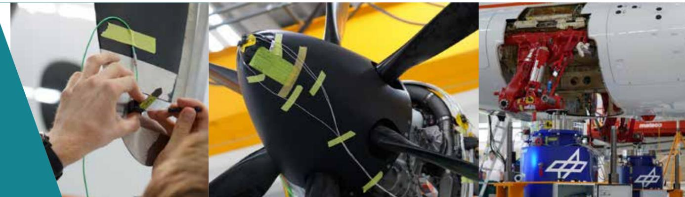
Das Testteam des DLR-Instituts für Aeroelastik in Göttingen stattete jedes Bauteil mit Sensoren aus, um das Schwingungsverhalten des DLR-Forschungsflugzeugs D328<sup>®</sup> UpLift genau zu vermessen.
