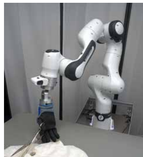
Beim Recycling von Textilien müssen unter anderem Knöpfe entfernt werden. Zurzeit geschieht das von Hand, weil es für Roboter noch zu schwierig ist. Hierfür will das „FlexCycle“-Team Lösungen finden. Foto: Universität Göttingen
