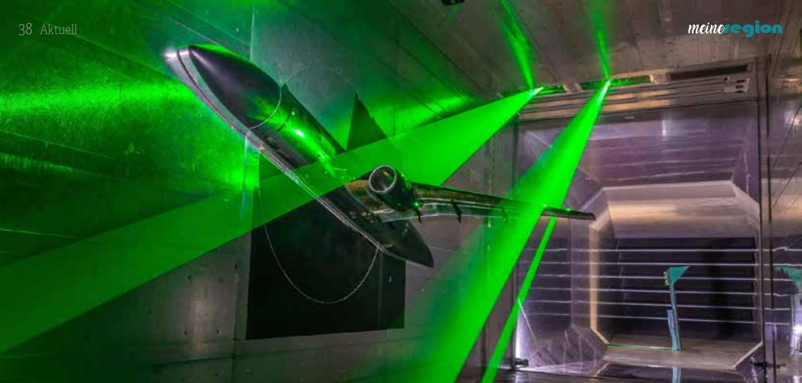
Flugzeugmodell der NASA im DNW-NWB: Laserlichtschnitte am Innen- und Außenflügel für die Messung von Strömungsgeschwindigkeiten
