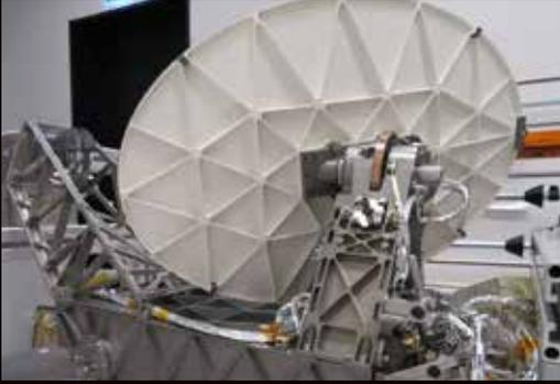
Schwenkbare Antenne und Empfängermodul von SWI. © MPS
